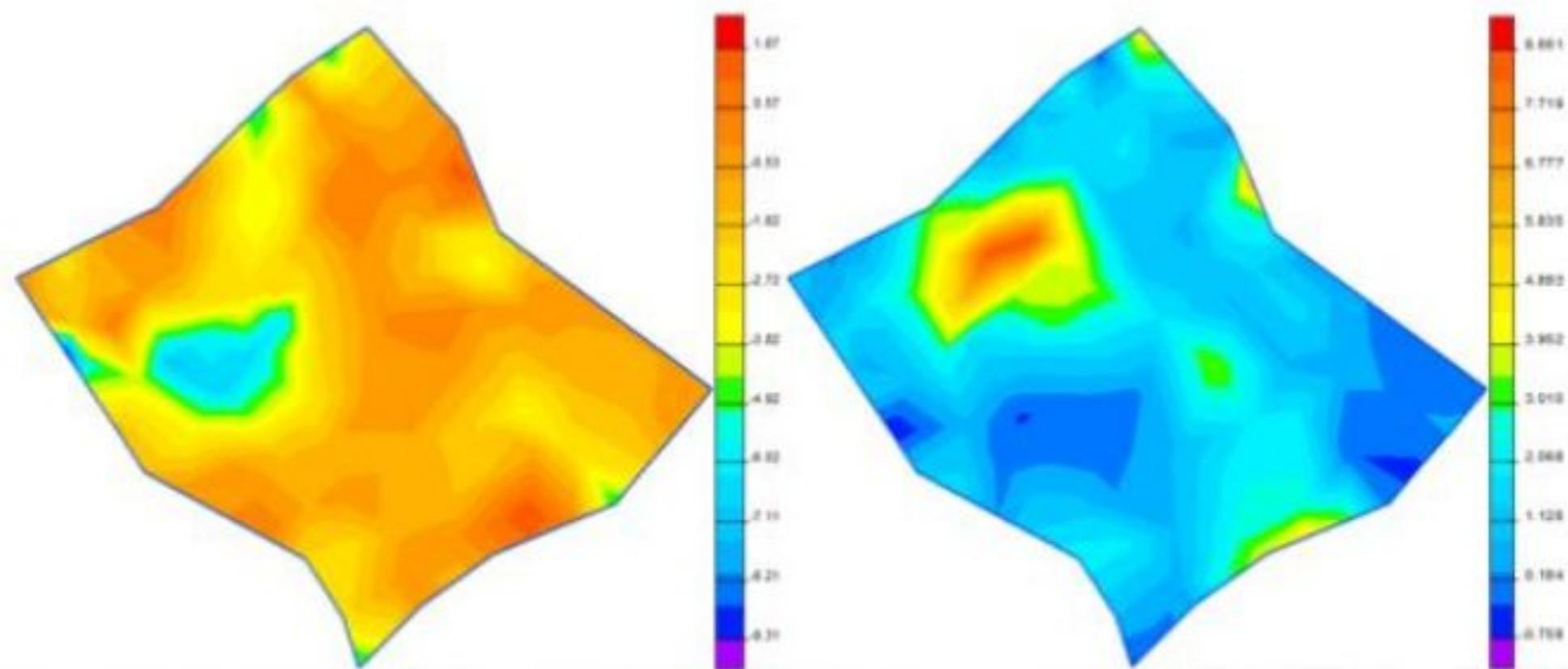
Рис. 13. Главная деформация  $\epsilon_1$  ( $10^{-5}$ ) Рис. 14. Главная деформация  $\epsilon_2$  ( $10^{-5}$ )
