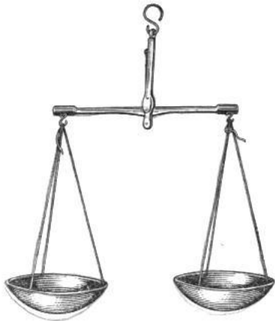
Рис. 3. Весы аптекарские ручные.
