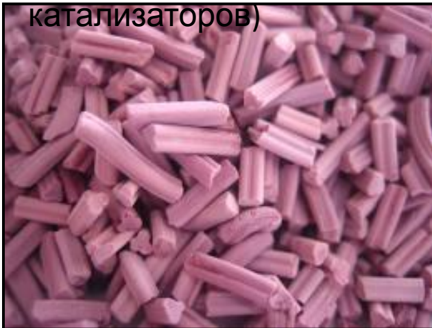
Рисунок 5. Катализатор ИК-ГО-1 для глубокой гидроочистки дизельных топлив (Институт катализа СО РАН)
