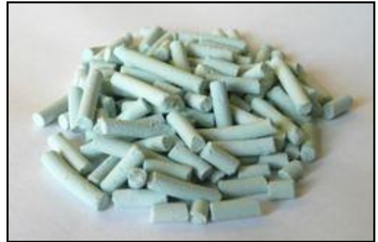
Рисунок 4. Катализатор гидроочистки дизельных фракций НК-233 (Новокуйбышевский завод катализаторов)
