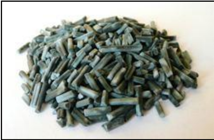
Рисунок 3. Катализатор гидроочистки дизельных фракций НК-232 (Новокуйбышевский завод катализаторов)
