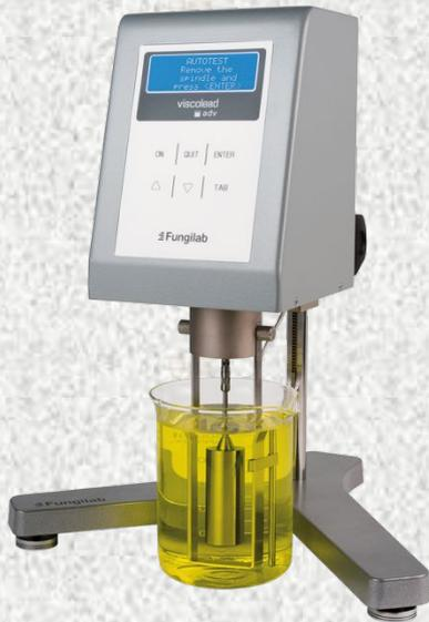
Метод предназначен для измерения вязкости ньютоновских и неньютоновских жидкостей в широком интервале температур, скоростей сдвига. Допустимы значения вязкости от  $10^{-3}$  до  $10^4$  Па\*с. Возможны измерения в осциллирующем режиме.
