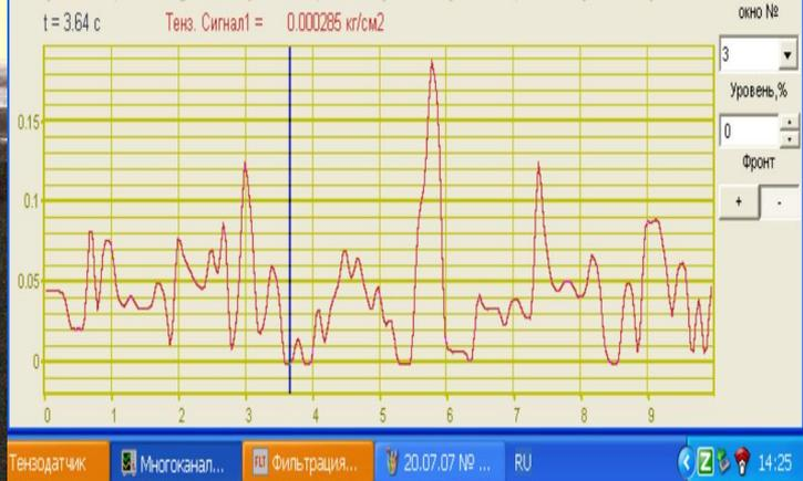
Зависимость размахов напряжений в несущих металлоконструкциях карьерного автосамосвала БелАЗ-75131 от скорости движения и высоты неровности микропрофиля в грузе
