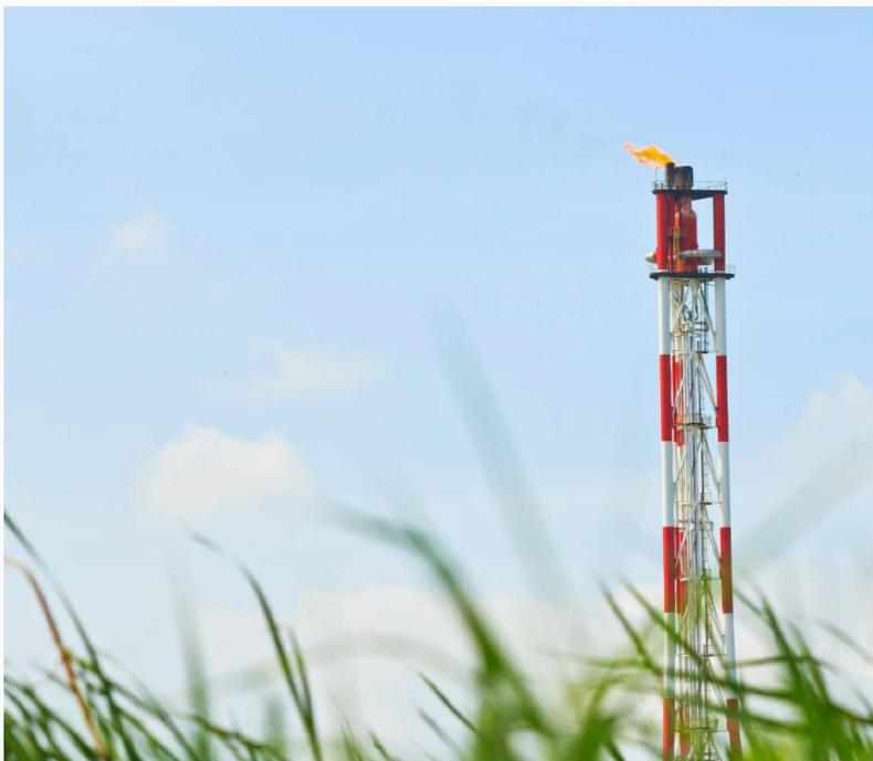
Комплектность и тип факельной установки (вертикальная, горизонтальная, одноствольная, совмещенная) выбирается в зависимости от особенностей рабочей площадки и параметров среды. Оборудование может быть как стационарным, так и мобильным.
