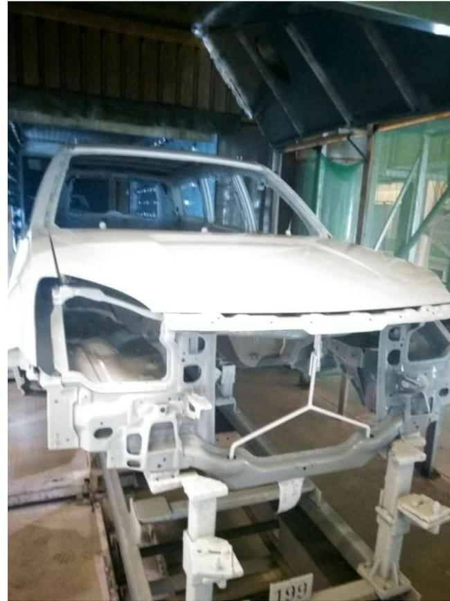
Кузов после нанесения базового покрытия Car body after Base Coat (BC)
