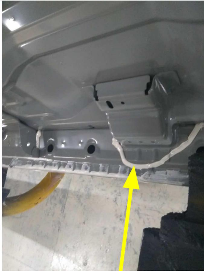
Нанесенный герметик роботами на днище кузова
