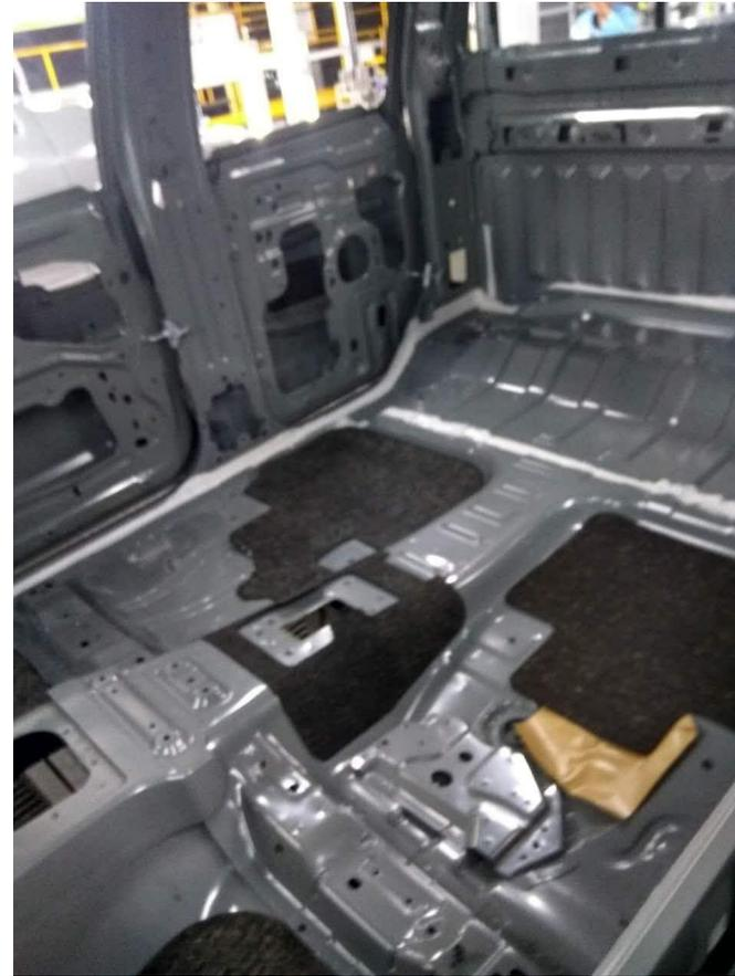
Кузов после нанесения герметика
