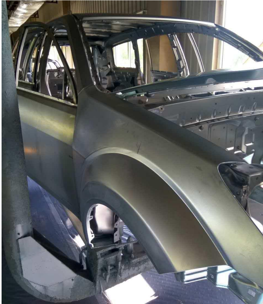
Кузов до нанесения катафореза Car body before ED 车身电泳前 chēshēn diànyǒng qián
