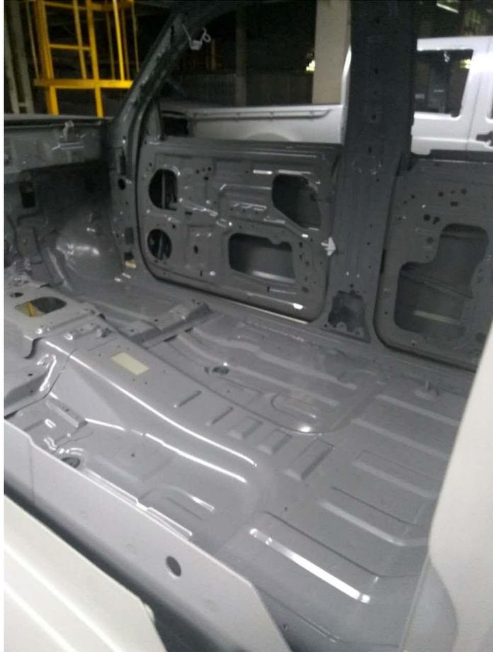
Кузов до нанесения герметика роботами
