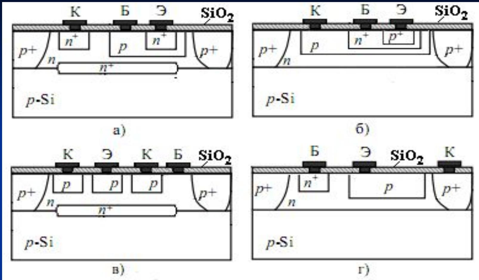
а) n-p-n-транзистор; б) вертикальный р-п-р-транзистор, полученный методом тройной диффузии; в) горизонтальный р-п-р-транзистор; г) вертикальный р-п-р-транзистор, использующий подложку в качестве коллектора.
