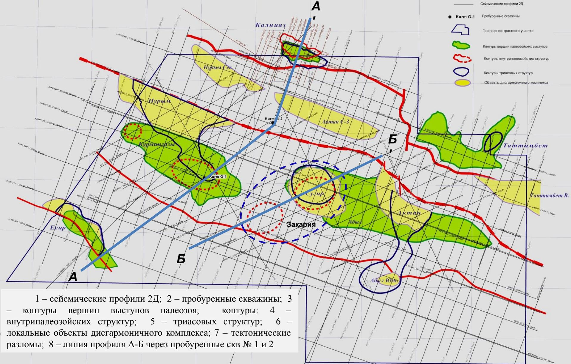
1 – сейсмические профили 2Д; 2 – пробуренные скважины; 3 – контуры вершин выступов палеозоя; контуры: 4 – внутрипалеозойских структур; 5 – триасовых структур; 6 – локальные объекты дисгармоничного комплекса; 7 – тектонические разломы; 8 – линия профиля А-Б через пробуренные скв № 1 и 2
