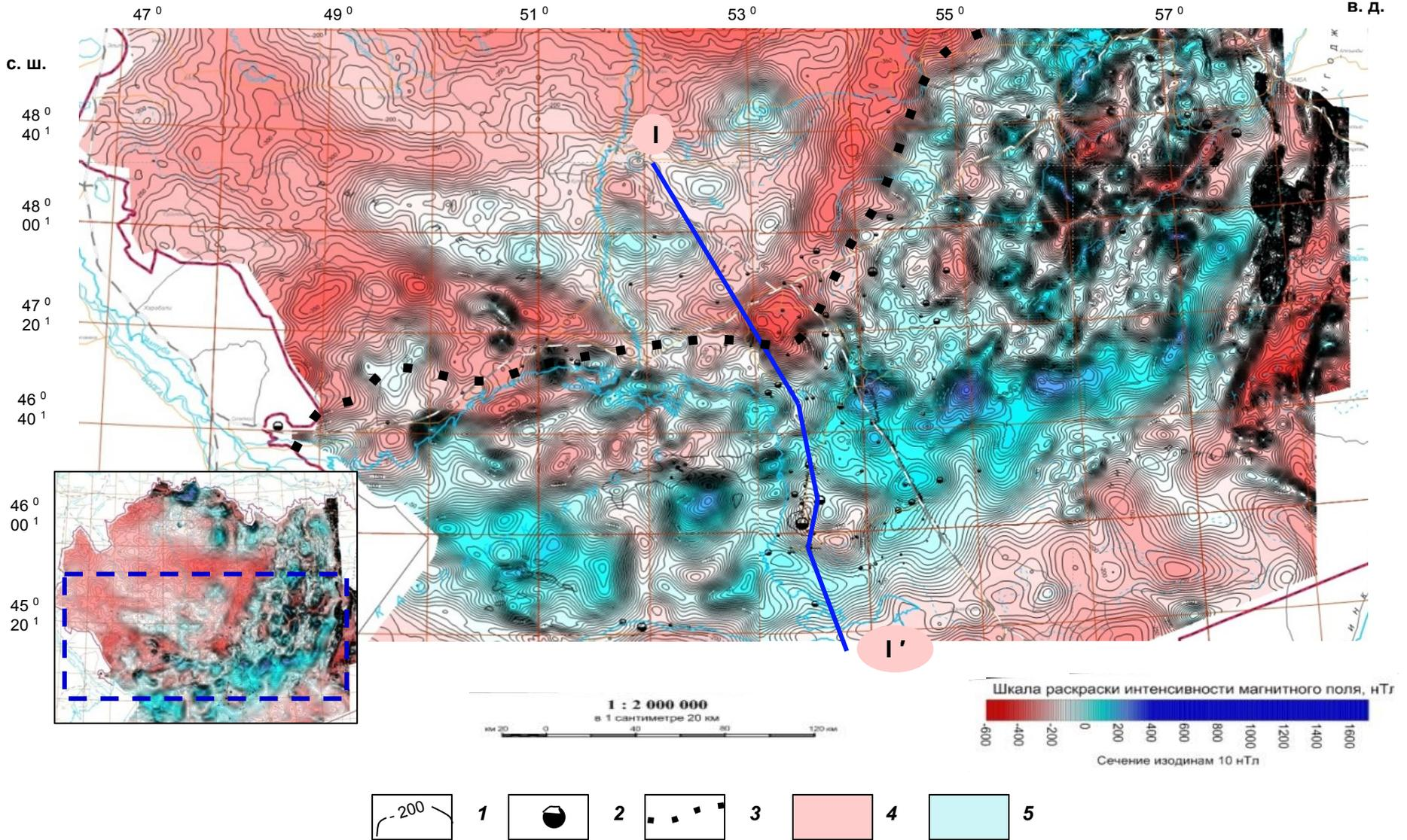
1 – изолинии значений АМП, нТл; 2 – месторождения углеводородов; 3 – линия, обозначающая передний край геомагнитной ступени; 4–5 – области значений АМП: 4 – пониженного, 5 – повышенного
