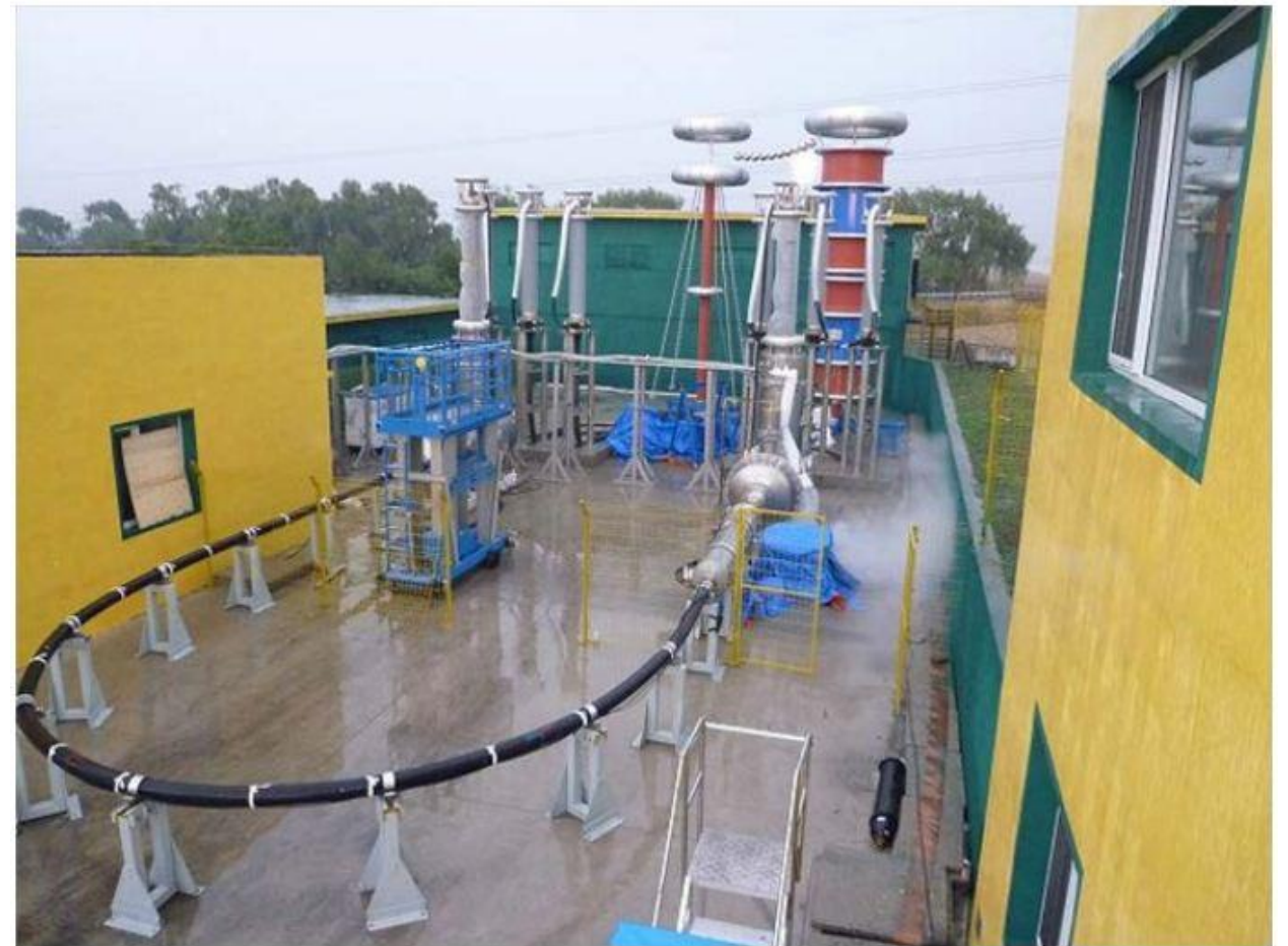
Однофазный ВТСП кабель установленный в Шеньян, Китай
