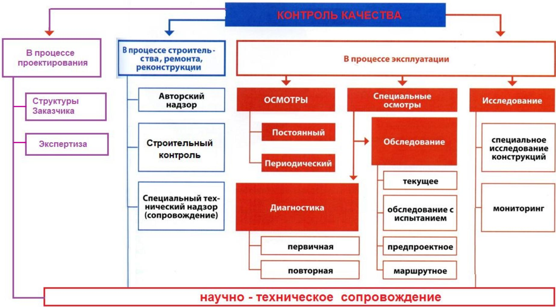
Контроль качества – это проверка соответствия количественных или качественных характеристик конструкции или сооружения, установленным техническим требованиям
