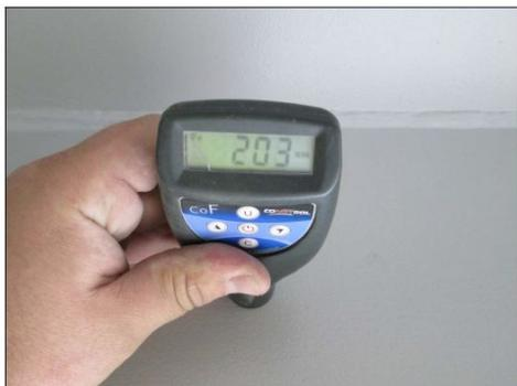
Определение толщины лакокрасочного покрытия прибором COF
