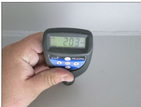
Определение толщины лакокрасочного покрытия прибором COF
