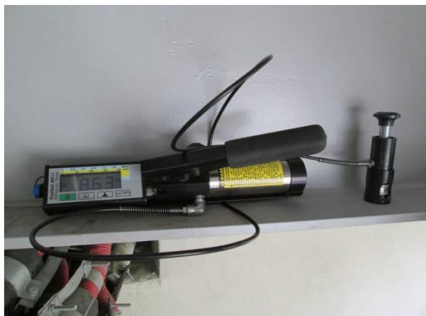
Гидравлический адгезиометр Elcometer 109
