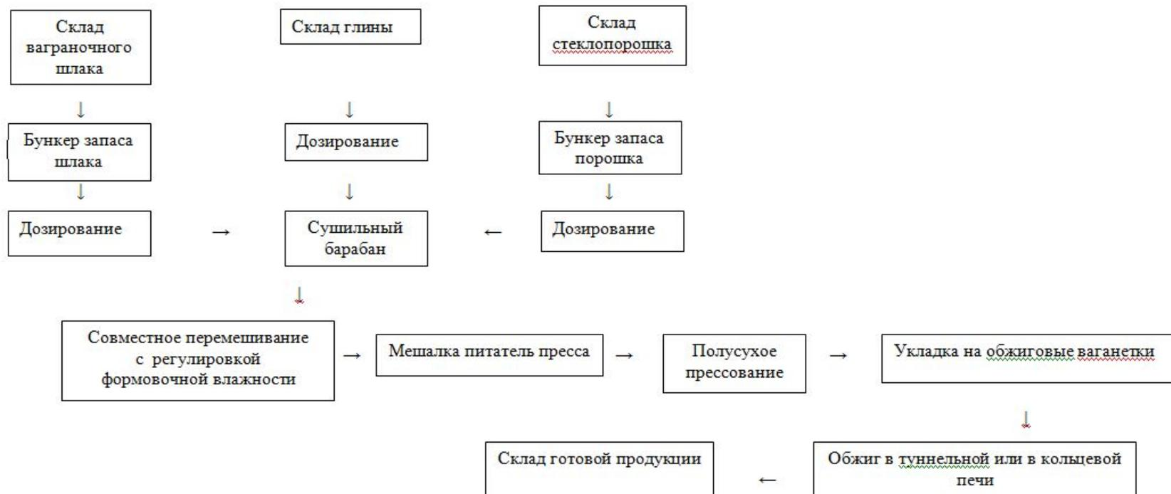
Технологическая схема производства стеновой керамики на основе разработанной керамической композиции
