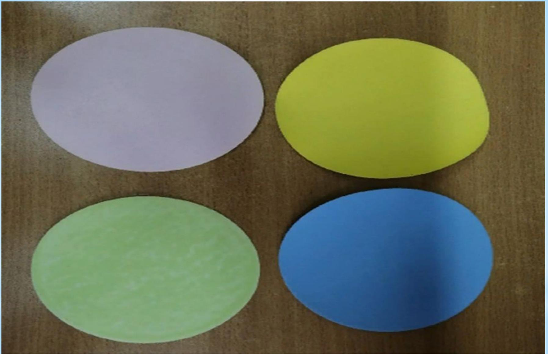
Рис. 8 – Фото алюминий-оксидных дисков (фирмы **Buehler**).
