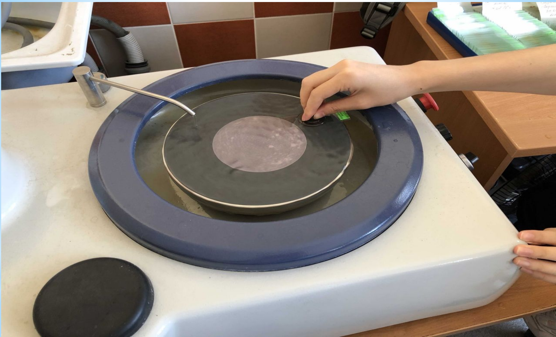
Рис. 4 – Фото процесса изготовления шлифа отолита на шлифовальной установке Buehler Metaserv250 .
