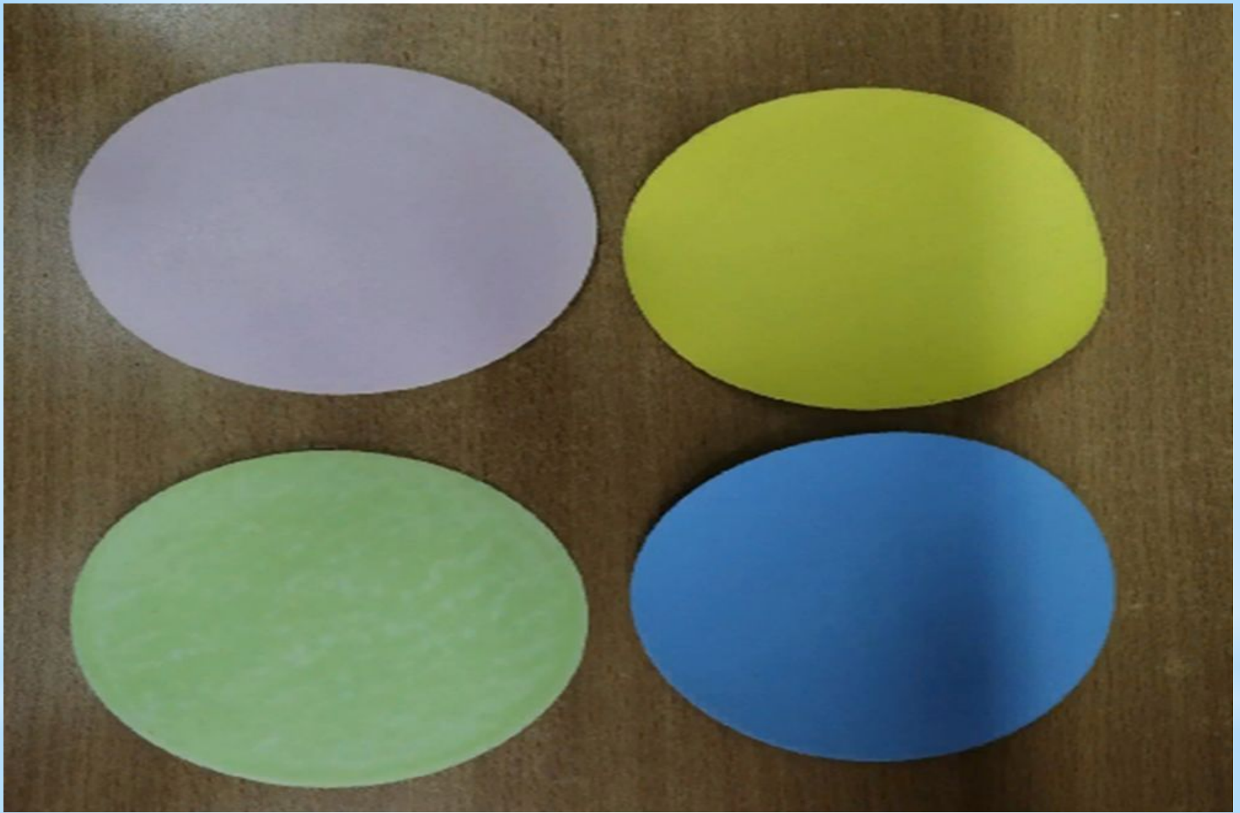
Рис. 8 – Фото алюминий-оксидных дисков (фирмы Buehler ).
