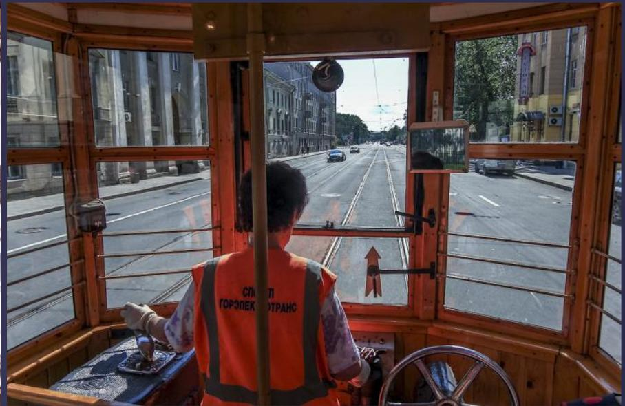
Интерьер трамвая был деревянный. В салоне были продольные (вдоль окон) деревянные скамейки на 12 пассажиров. Конструкция вагона была двухголовая, и место управления было с обоих концов вагона. Двери также имелись справа и слева по ходу движения
