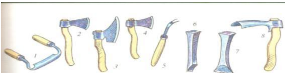
Плотницкий инструмент: 1. Струг. 2. Топор дровосечный. 3. Потес. 4. Топор плотницкий. 5. Черта. 6. Долото. 7. Просека. 8. Тесло.
