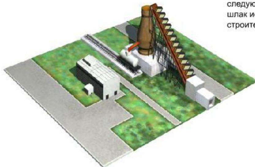
Агломерат (железосодержащее сырье) и кокс (топливо) загружаются в доменную печь. Внутри печи подают нагретый воздух и природный газ. В ходе доменного процесса происходит образование чугуна и шлака (отходы). Полученный чугун передается на следующие этапы производства, а шлак используется для изготовления строительных материалов.
