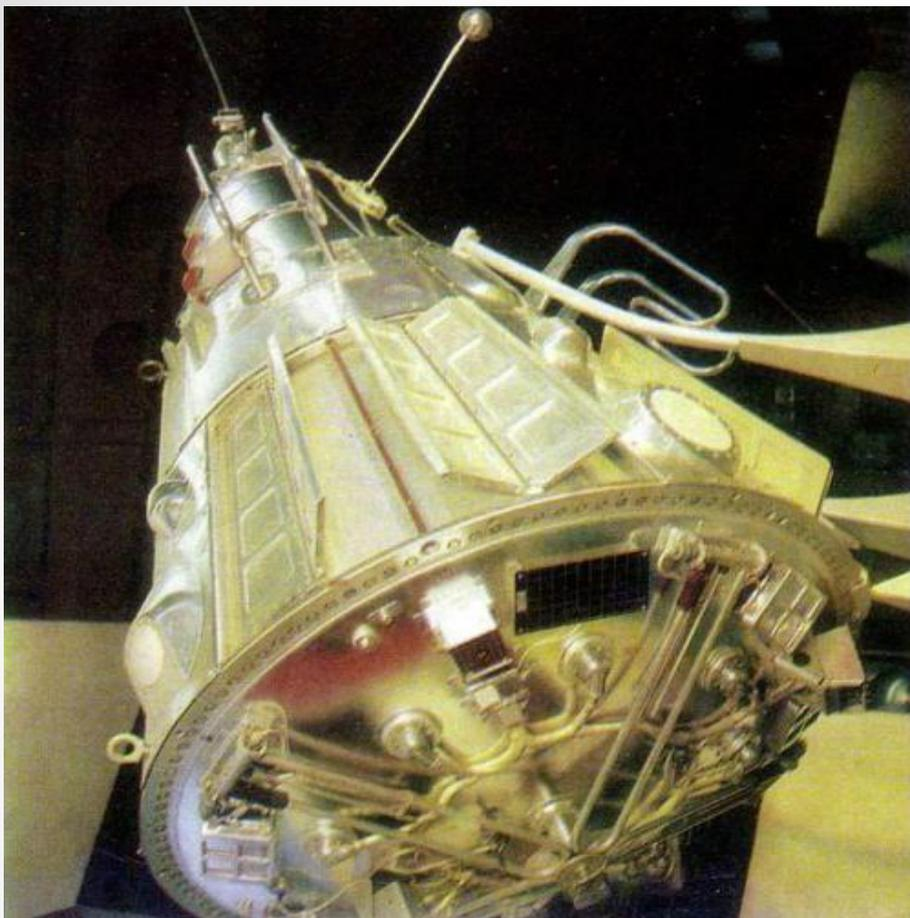
Кремниевые панели солнечных батарей были установлены на днище и в носовой части Спутника-3. Такое расположение позволило получать дополнительную электроэнергию практически непрерывно, независимо от положения спутника на орбите относительно солнца. 15 мая 1958 года, в Советском Союзе был выведен на эллиптическую орбиту вокруг Земли Спутник-3 с солнечными батареями на борту.
