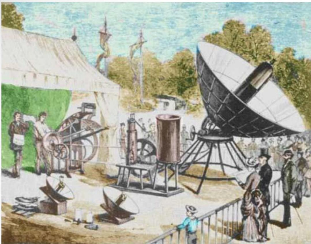
Первые солнечные батареи, способные преобразовывать солнечную энергию в механическую энергию пара, были построены во Франции. В конце XIX в. на Всемирной выставке в Париже изобретатель О. Мушо демонстрировал инсолятор - аппарат, который при помощи зеркала фокусировал лучи на паровом котле. Котел приводил в действие печатную машину, печатавшую по 500 оттисков газеты в час. Через несколько лет в США построили подобный аппарат мощностью в 15 лошадиных сил
