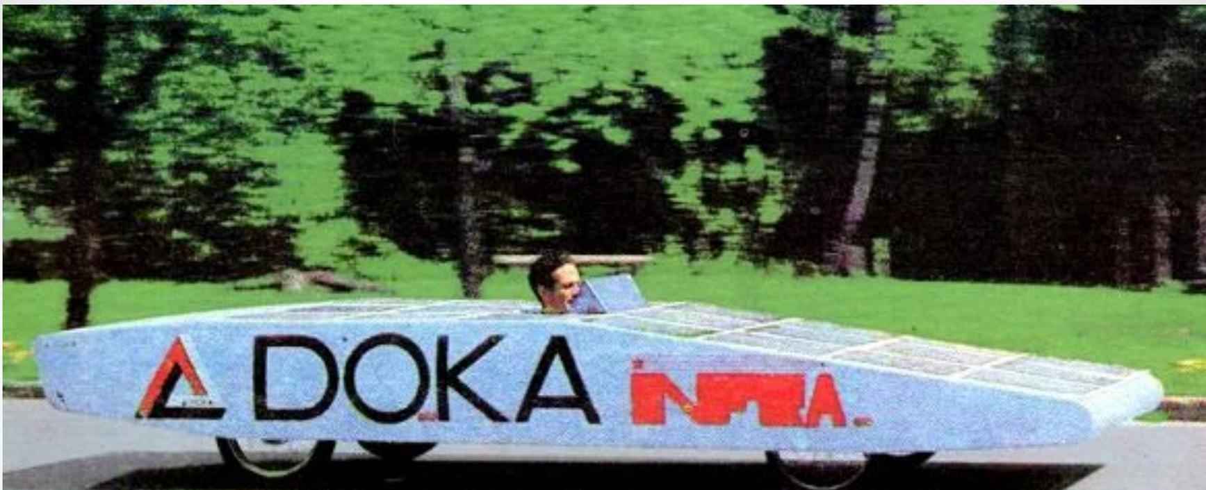
*Солнцемобиль «ДОКА-гелио». Масса с аккумуляторами — 170 кг, максимальная скорость — 53 км/ч, площадь фотоэлементов — 6 м<sup>2</sup>, номинальная мощность элементов — 720 Вт, длина — 4500 мм, ширина — 1500 мм, высота — 800 мм.*
