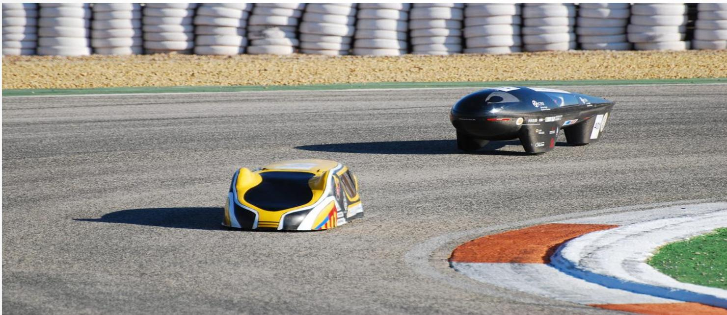
Еще один минус этих автомобилей – мощность. Они развивают не многим больше 1 л. с. и это при условии, что площадь фотоэлементов приблизительно два квадратных метра, поэтому скорость таких машин тоже не велика. 100 км/ч, при хорошей погоде и попутном ветре, считается очень хорошим показателем.
