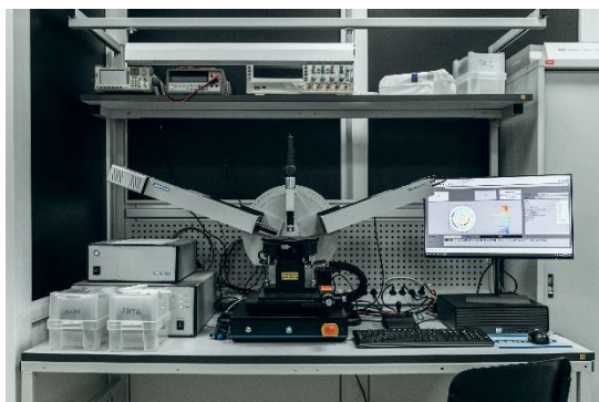
Спектроскопический эллипсометр для измерения диэлектрических параметров тонких пластин
