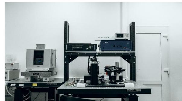
Установка стыковки ИО чипов с оптоволоконными модулями ввода/вывода света и измерение их оптических параметров
