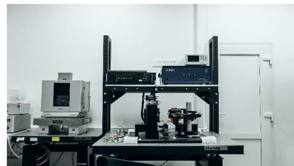
Установка стыковки ИО чипов с оптоволоконными модулями ввода/вывода света и измерение их оптических параметров
