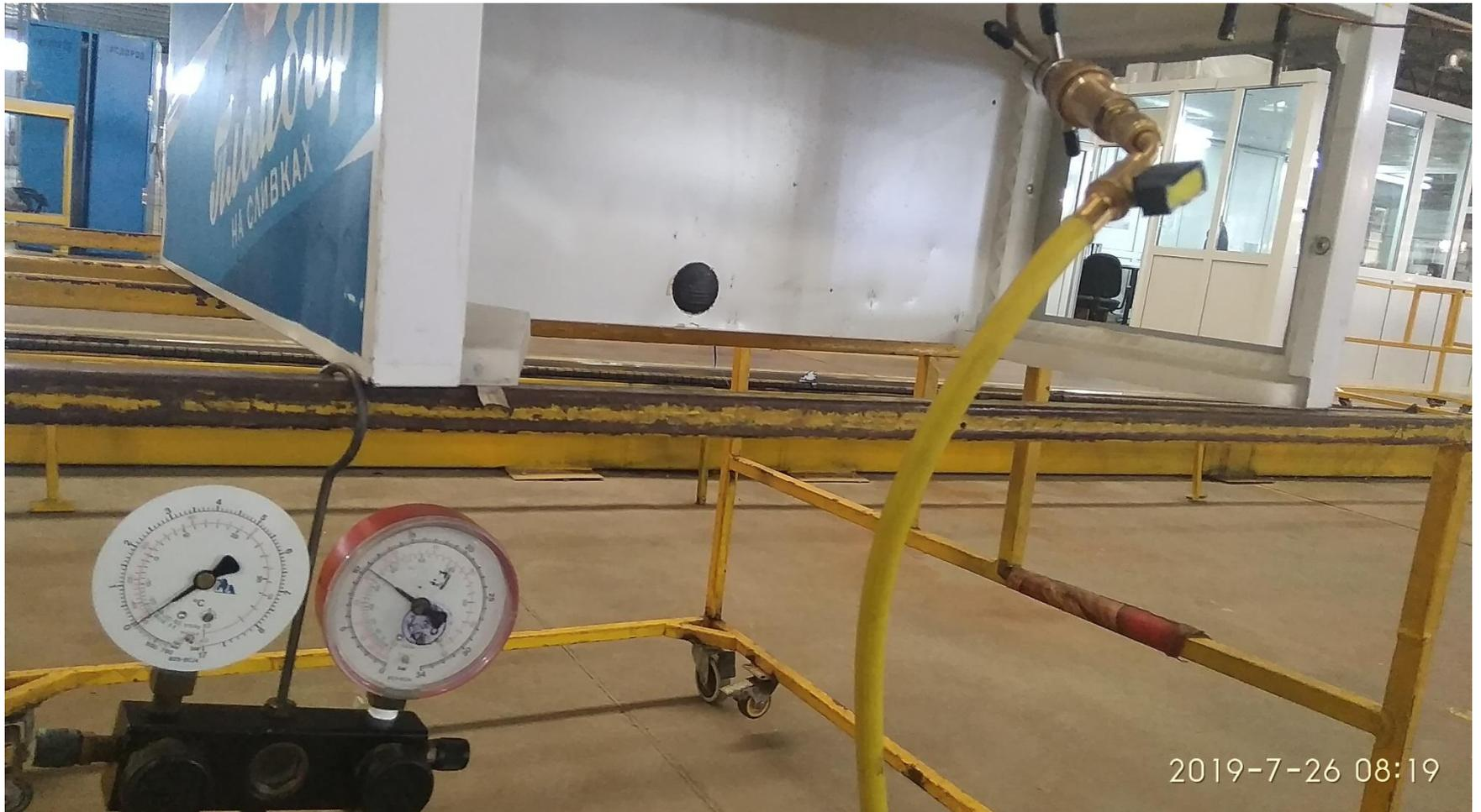
**Проверен контур подогрева, также течеискателем и проверкой избыточным давлением гелия на падение давления.**
