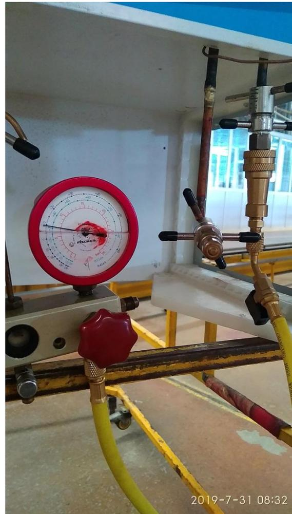
**В ходе проведенных испытаний течеискателем и избыточным давлением гелия утечек в корпусе не обнаружено.**
