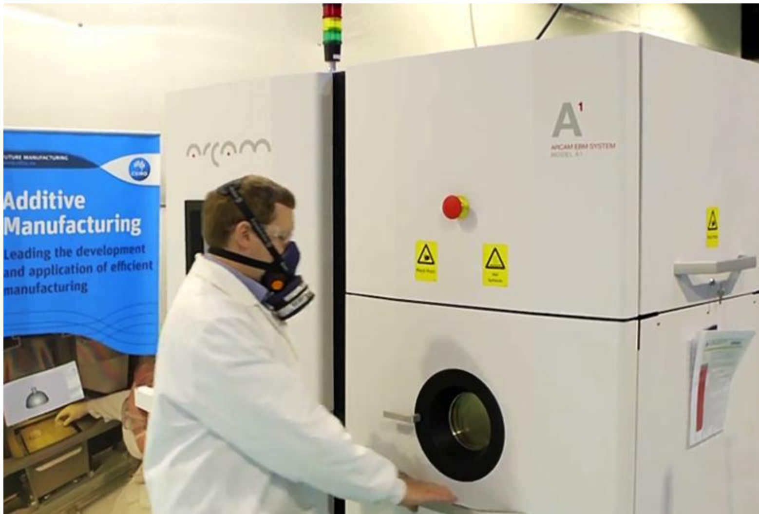
3D-принтер производства Arcam A1 с технологией электронно-лучевой плавки (фото: CSIRO)
