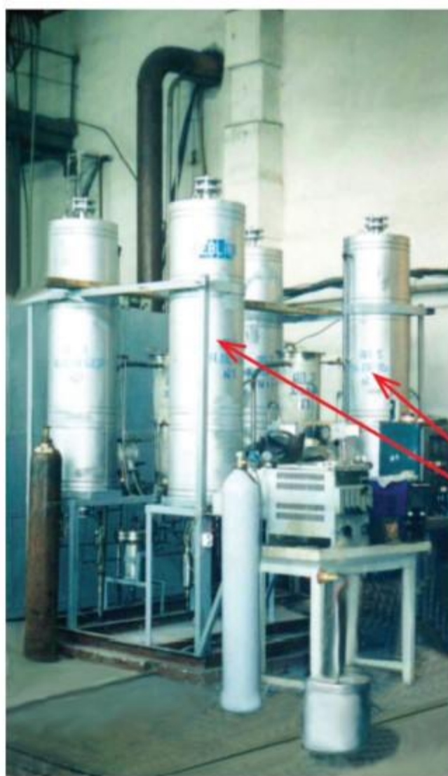
общий вид блока для каталитической очистки потока от водорода: X – холодильник; R – реактор; ФС2 – фазовый сепаратор (отделение конденсата H 2 O); АО – адсорбер-осушитель; ТО1 и ТО2 – теплообменники; А1 и А2 – низкотемпературные адсорберы
