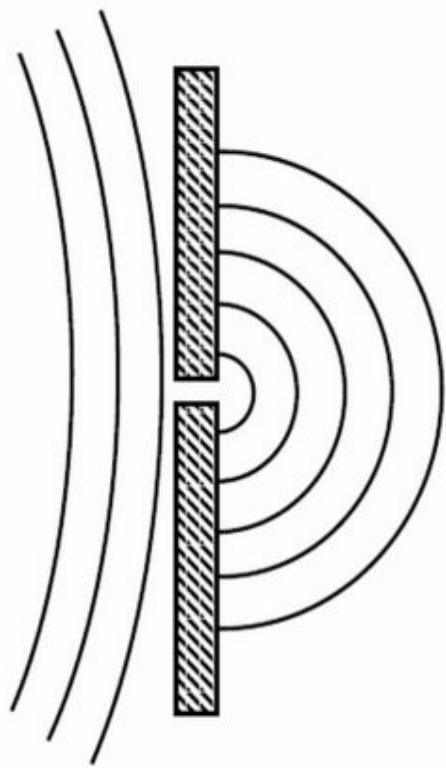
*Рис. 51.1. Малое отверстие в преграде – источник сферических волн*
