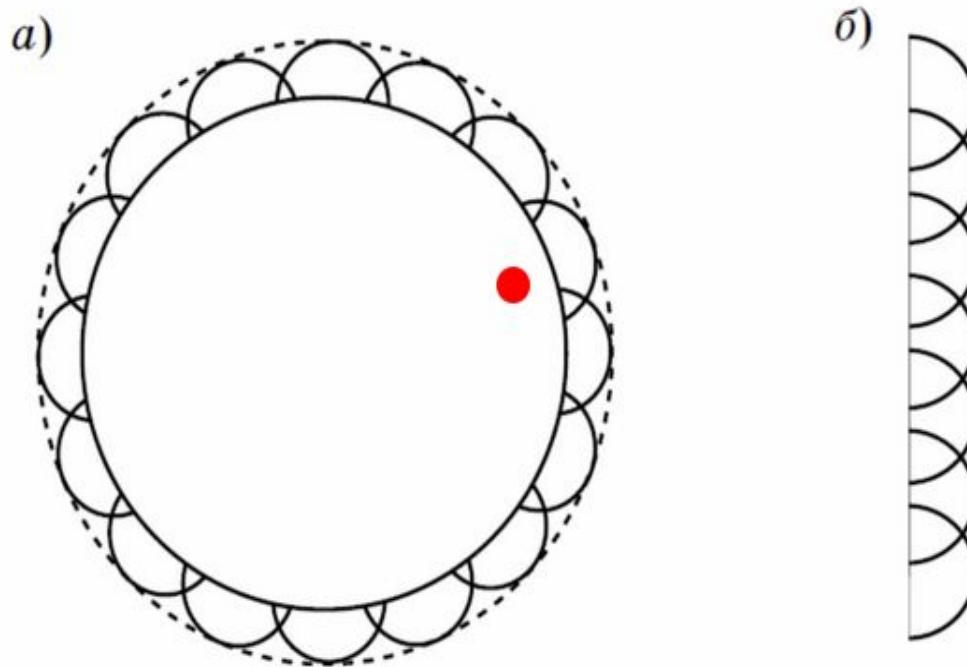
Рис. 51.3. Построения Гюйгенса для сферической (а) и плоской (б) волн
