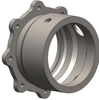
*Твердотельная модель детали Корпус*
