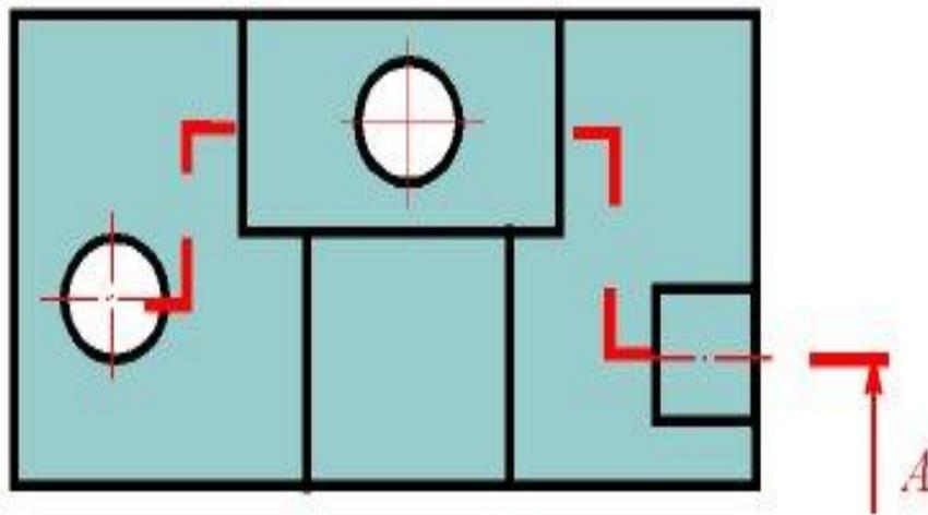
*Положение секущей плоскости указывают на чертеже линией сечения. Для линии сечения применяется разомкнутая линия. При сложном разрезе штрихи проводят также у мест пересечения секущих плоскостей. На начальном и конечном штрихах ставят стрелки, указывающие направление взгляда. Разрез должен быть отмечен надписью из двух одинаковых букв, написанных через тире, например, *A-A**
