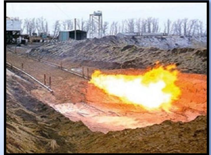
Рис.10 промышленное сжигание остаточного газа
