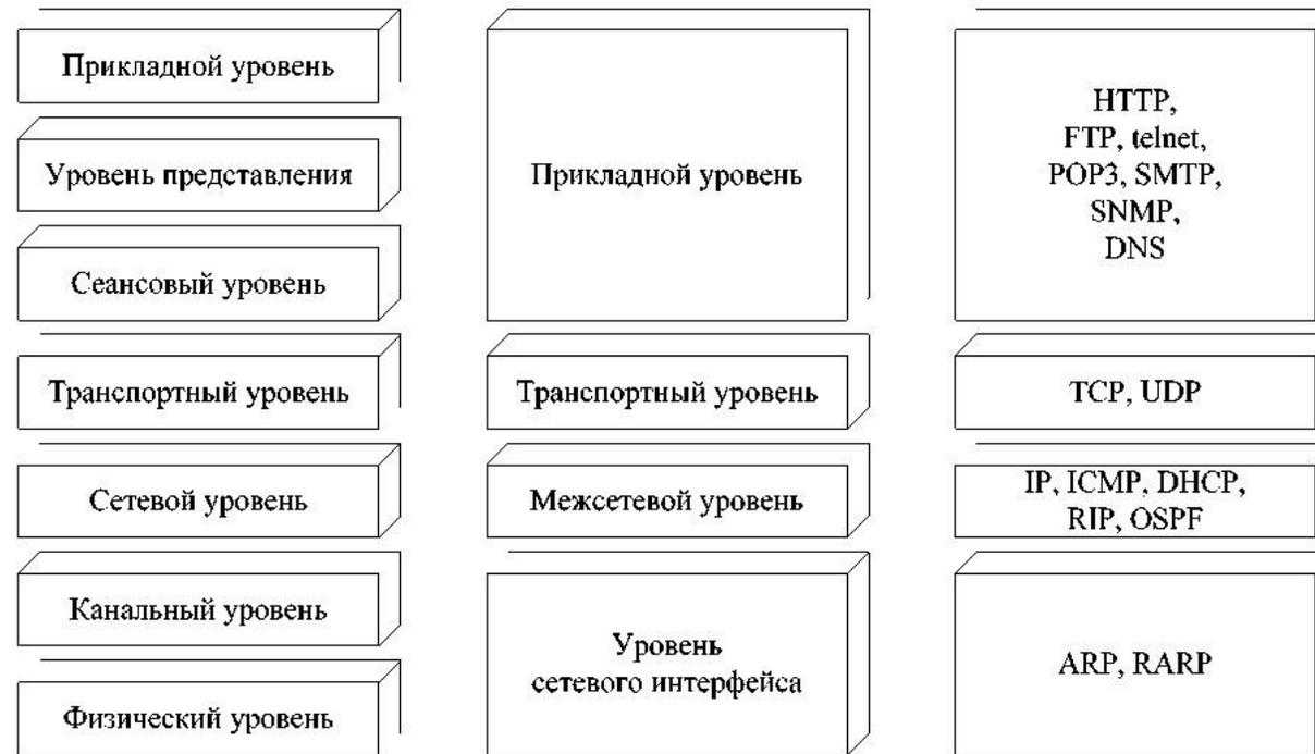
Рис. 2.2. Соответствие протоколов TCP/IP моделям OSI и DARPA
