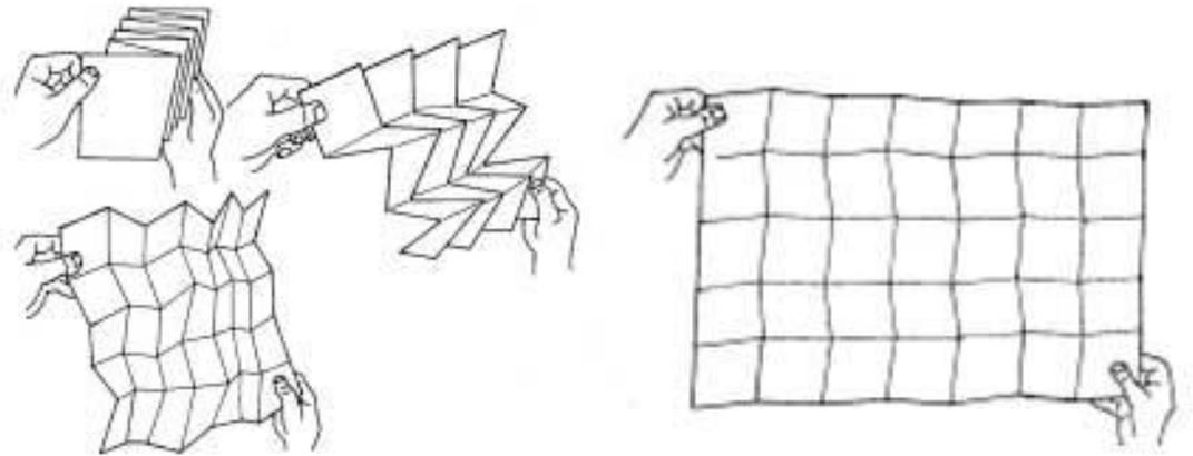
Ученые анализировали возможность применения принципов жёсткого оригами для космического корабля, использующего в качестве двигателя солнечный или электрический парус. Такие космические паруса должны иметь большую площадь, а значит необходимо отработать дешёвую, но надёжную схему их транспортировки с Земли.
