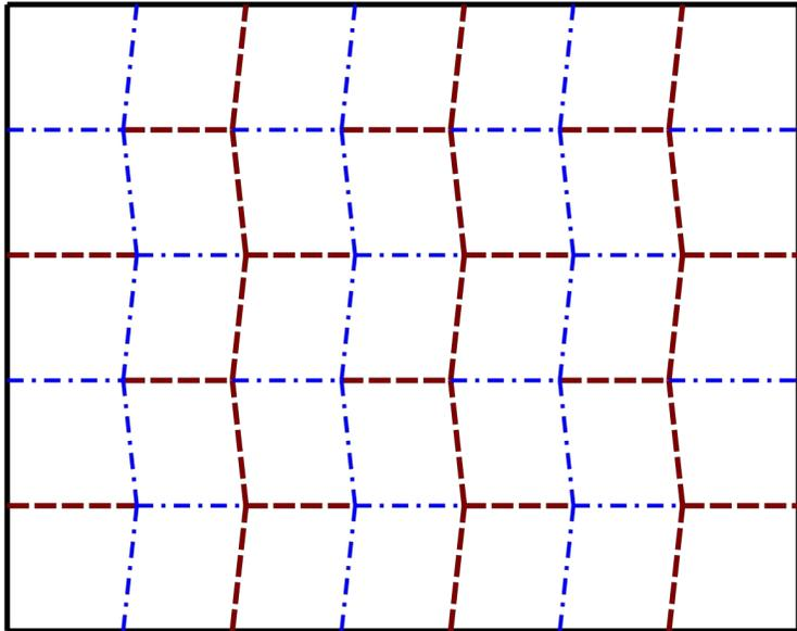
Самой известной и распространённой инженерной находкой оригами стала схема Миура-ори.
