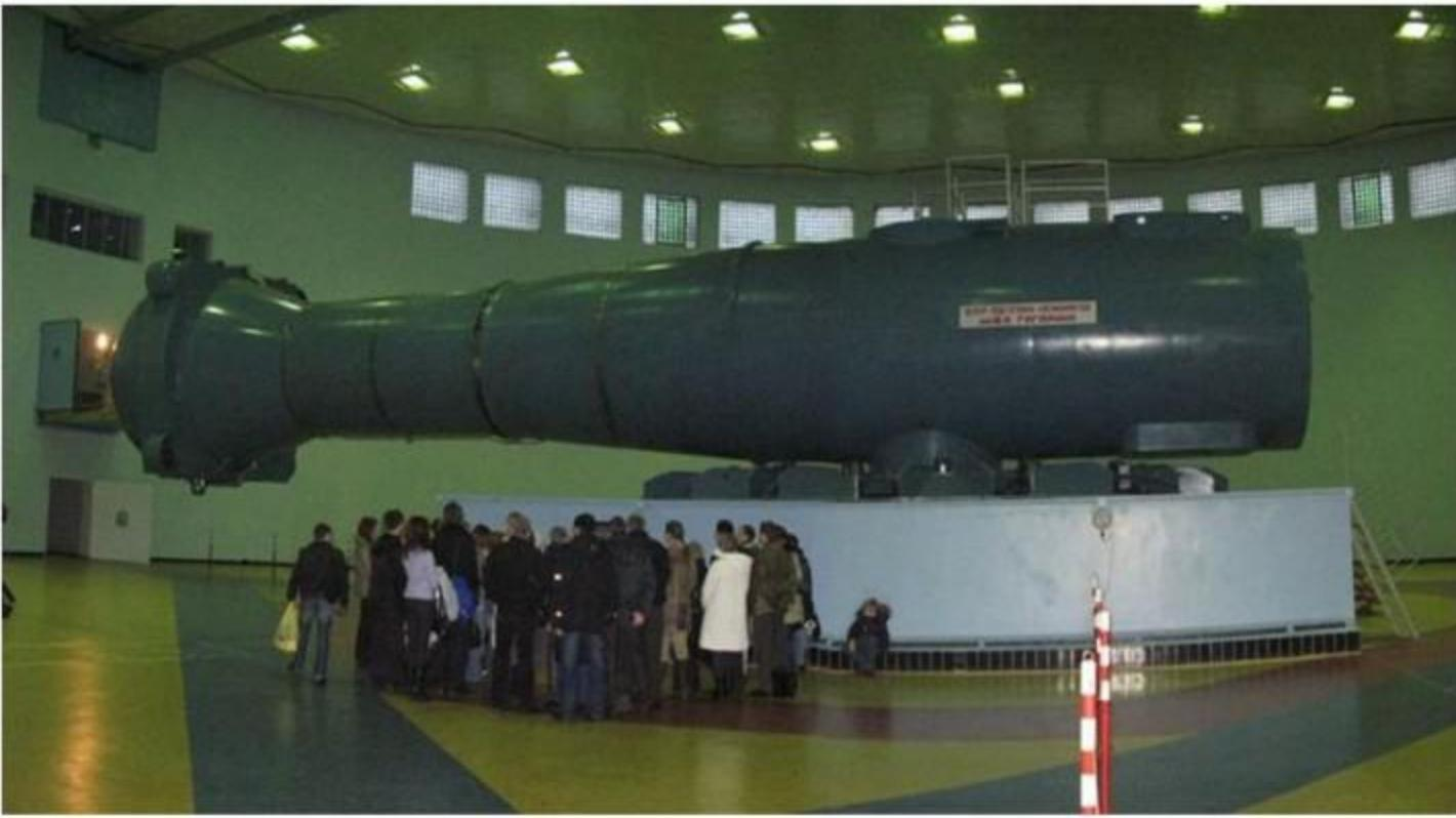
Для тренировок космонавтов используют тренажер – центрифугу. В этой огромной, 18-метровой кегле создаются перегрузки, которые космонавт испытывает во время полета. Сама она вращается по кругу, голова ее тоже вращается, внутри головы вращается кабина, а внутри кабины вращается кресло с космонавтом.
